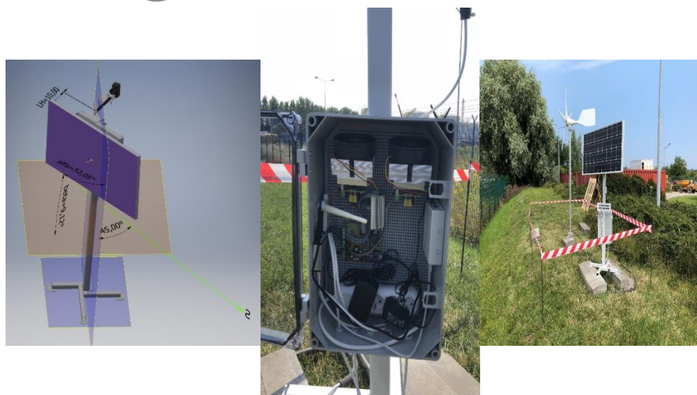
Rysunek 11 Schemat blokowy układu do badania systemów zasilania Inteligentnych Znaków Drogowych (a) oraz schemat układu mechanicznego do pozycjonowania panelu solarnego i widok instalacji testowej (b)
