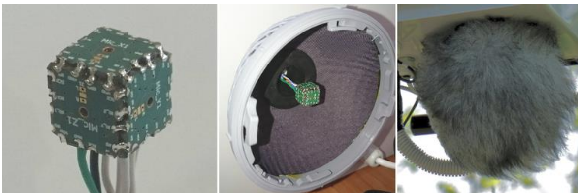
Rysunek 7 Akustyczny czujnik wektorowy: (a) kostka mikrofonowa (powiększenie), (b) kostka zamocowana w osłonie, (c) czujnik zamontowany na zewnątrz obudowy demonstratora Inteligentnego Znaku Drogowego.
