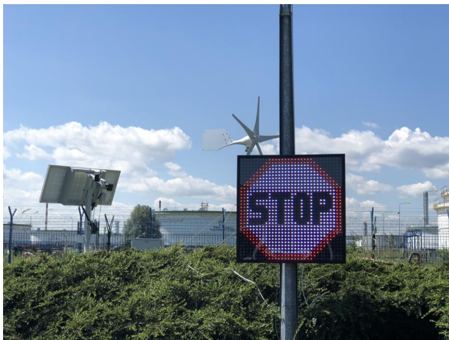
Rysunek 15 Wyświetlacz wytworzony dla potrzeb demonstratora technologicznego. Na tylnym planie widać elementy skonstruowanej instalacji autonomicznego zasilania: samopozycjonujący się panel solarny i turbinę wiatrową.
