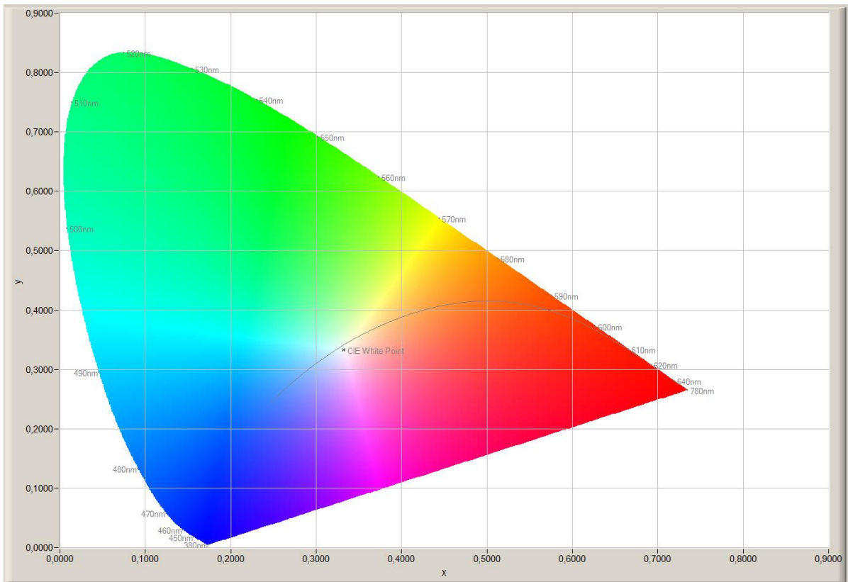
Rysunek 13 Podgląd na wykres chromatyczności po korekcji kolorów RGB, wygenerowany w trakcie prac badawczych nad opracowaniem panelu LED
